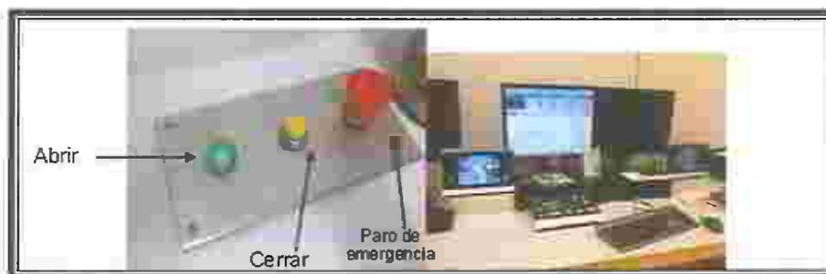
Fig. 4. Botones de apertura y cierre de puerta del búnker donde se encuentra el acelerador lineal TrueBeam.
