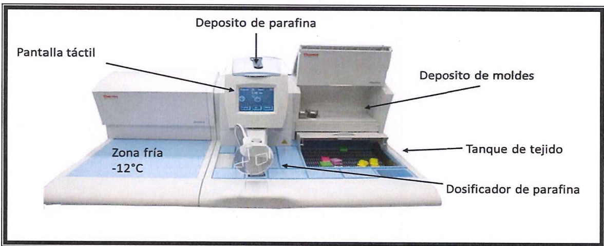
Fig. 3 Equipo de inclusión en parafina (HistoStar, Thermo Scientific)
